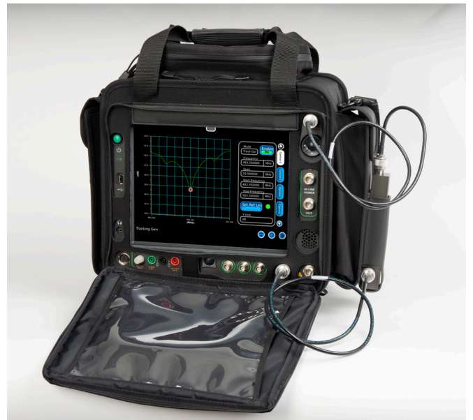
8800SX в мягком чехле с подключенным переходником для измерения возвратных потерь
